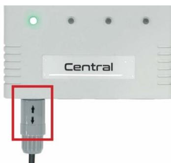
2. С помощью USB-кабеля подсоедините центральный модуль к компьютеру. При правильном подключении светодиод на центральном модуле, соответствующий подключенному порту, должен начать мигать — это означает передачу данных,
